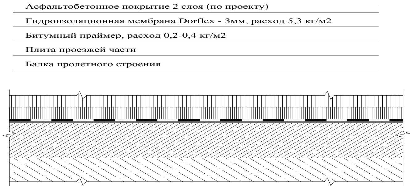
Рис. 2. Конструкция дорожной одежды без защитного слоя.
